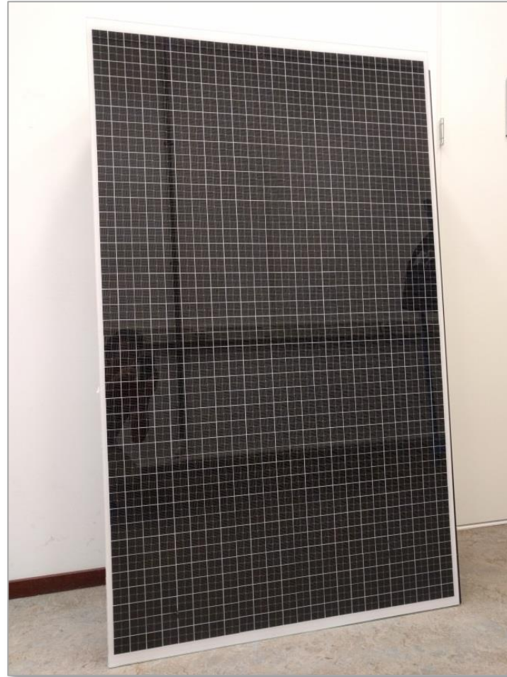
Prototype van schaduwlineaire module (ECN)
