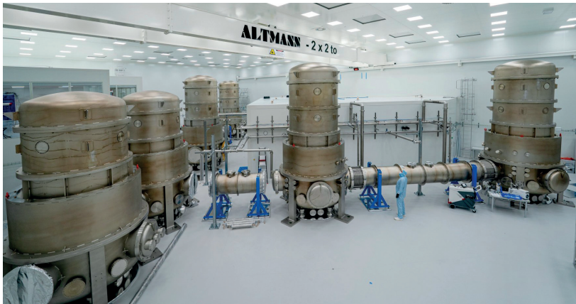
Figuur 2. Foto van het ETPF-lab in Maastricht. De optica wordt trillingsvrij opgehangen in de torens, die met elkaar verbonden zijn door vacuüm buizen. De torens zijn minder hoog, omdat de spiegels kleiner zijn dan die gepland in de Einstein Telescoop. Afbeelding: The ETPfinder Team.
